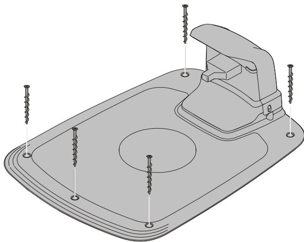
Säkra laddstationen mot marken med de fem medföljande fästskruvarna med hjälp av insexnyckeln på 6 mm.
