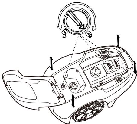
Rotiți butonul în poziția deblocată și ridicați cu fermitate unul dintre colțurile caroserie și repetați procedura pentru toate colțurile, până când corpul este detașat de șasiu.
