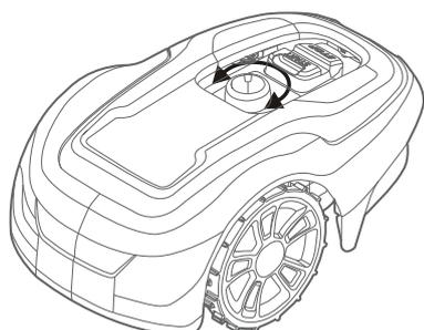
Během prvních několika týdnů sekání nastavte výšku sekání na 60 mm, aby nedošlo k přerážení ohraničujícího drátu a vodícího drátu. Poté každý týden snižte nastavení o jeden krok, až dosáhnete požadované výšky sekání.
