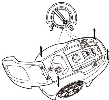
Rode o manípulo para a posição de desbloqueio e levante firmemente um dos cantos da estrutura e repita para todos os quatro cantos, até que a estrutura se solte do chassi.
