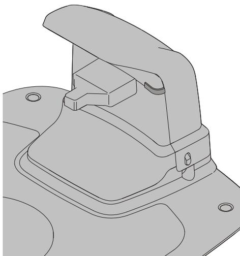
Kiinnitä latausasema maahan käyttäen viittä mukana toimitettua kiinnitysruvia ja 6 mm:n kuusiokoloavainta.
