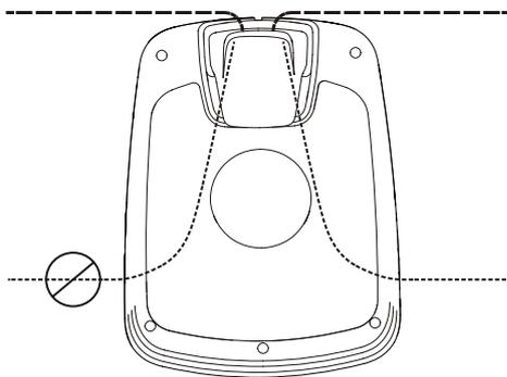
Întreaga stație de încărcare trebuie situată în interiorul zonei de operare, așa cum este indicat în figură.
