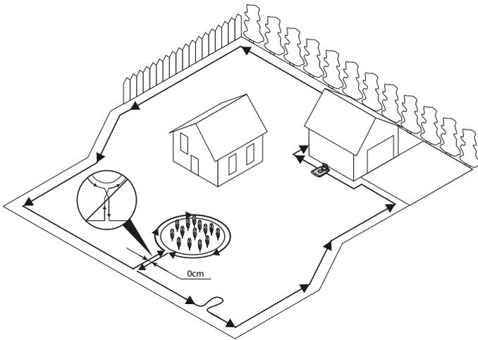
Fije temporalmente el extremo de la bobina de cable a una estacilla u otro objeto en la estación de carga.
