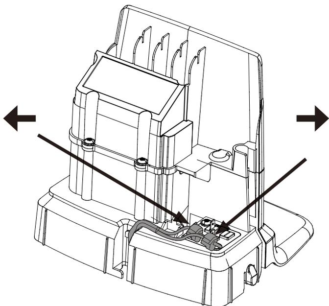
Подключите пограничный провод к зарядной станции следующим образом:
