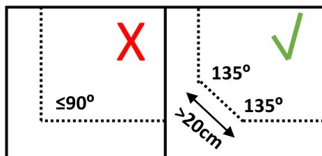
При прокладке кабеля, во избежание создания препятствий для перемещения газонокосилки, не допускайте поворотов провода под острым углом.
