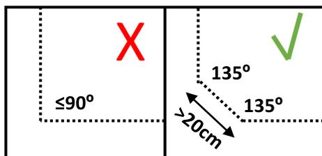
Sekačka používá volitelný vodící drát, aby našla cestu zpět do nabíjecí stanice, ale také k dosažení těžko přístupných oblastí v provozním prostoru. Vodící drát se například pokládá mezi nabíjecí stanicí a vzdálenou část pracovního prostoru nebo do úzkého průchodu.
