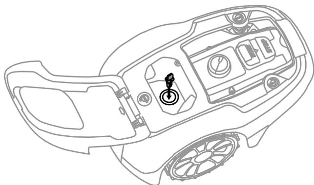
Sätt i säkerhetsnyckeln i gräsklipparen och vrid till positionen ON (I).
