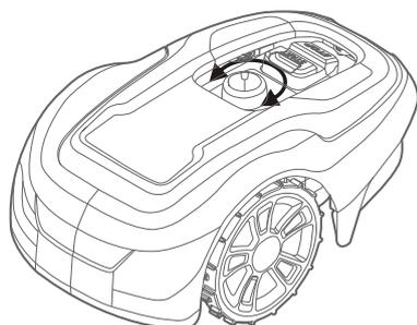
В течение нескольких первых недель эксплуатации высота скашивания травы должна составлять 60 мм, чтобы исключить контакта ножей с пограничным и направляющим проводами. Уменьшайте высоту скашивания травы каждую неделю, пока не будет достигнута желаемая высота скашивания.
