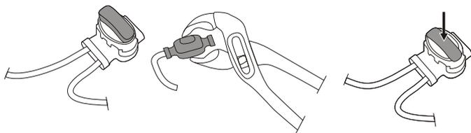
Si el cable delimitador es demasiado corto, utilice los conectores suministrados de empalme y de cable de guía para empalmar el cable delimitador adicional del siguiente modo:
