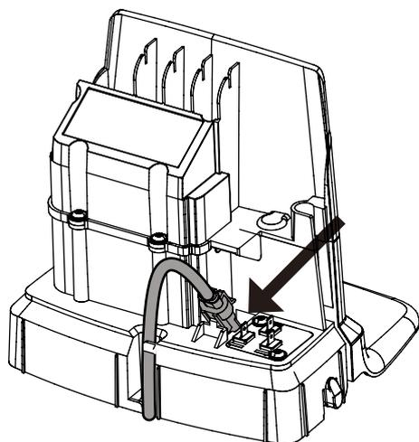
Sluit de laagspanningskabel aan op het laadstation.
