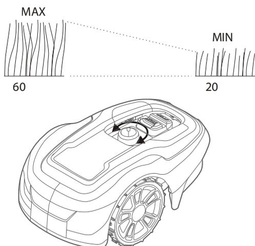
Durante las primeras semanas de corte, ajuste la altura de corte a 60 mm para evitar cortar el cable delimitador y el cable de guía. Posteriormente, baje el ajuste un paso cada semana hasta que se alcance la altura de corte deseada.
