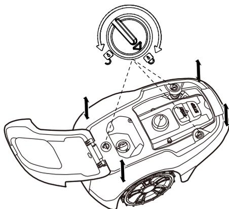
Otočte gombík do odomknutej polohy a pevne zdvihnite jeden z rohov krytu a zopakujte pre všetky štyri rohy, až kým sa kryt neuvoľní z podvozku.
