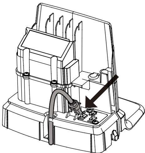
Conectați cablul de tensiune joasă la stația de încărcare.
