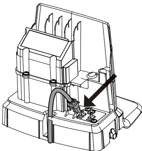
Csatlakoztassa a kisfeszültségű kábelt a töltőállomáshoz.
