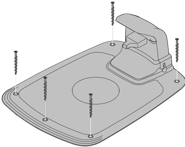
Fixez la station de charge au sol avec les cinq vis de fixation fournies à l'aide d'une clé hexagonale de 6 mm.
