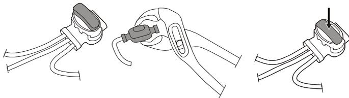
Inserte ambos extremos del cable delimitador así como el extremo del cable de guía en el conector de empalme y de cable de guía. Compruebe que los cables estén totalmente insertados en el conector de empalme y de cable de guía de manera que los extremos sean visibles a través del conector de empalme y de cable de guía.
