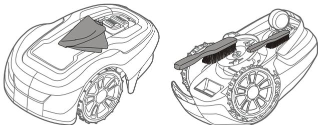
**VAROVANIE!** Stlačte tlačidlo STOP a pred čistením odstráňte bezpečnostný kľúč.
