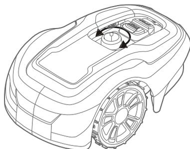
I de første par uger sættes klippehøjden til 60 mm for at undgå at klippe i afgrænsningskablet og styrekablet. Sænk indstillingen af klippehøjden et trin i de følgende uger, indtil den ønskede klippehøjde er nået.
