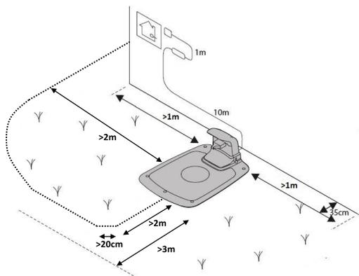
Întindeți firul spre bucla de pe firul delimitator unde urmează a fi conectat firul de ghidare.
