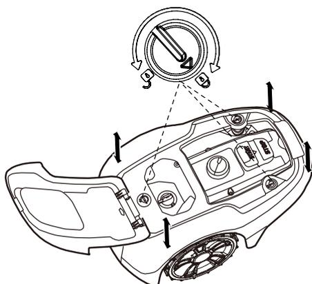
Obrócić pokrętko do pozycji odblokowującej i podnieść jej obudowę w jednym z rogów, po czym powtórzyć te same czynności we wszystkich 4 rogach, aż obudowa zostanie zdjęta z podwozia.
