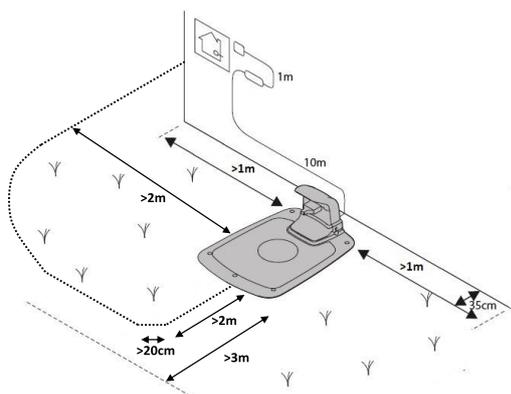
Connectez le fil de guidage à la boucle du fil périphérique à l'endroit planifié.
