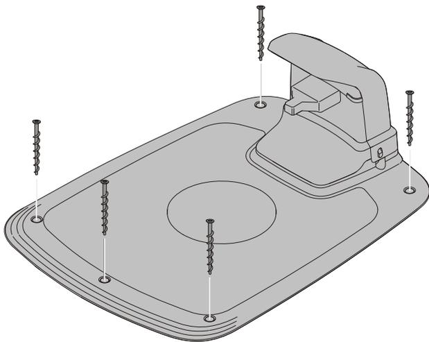
Закрепете зарядното устройство към земята с петте доставени фиксиращи винта като използвате шестостенен ключ 6 мм.
