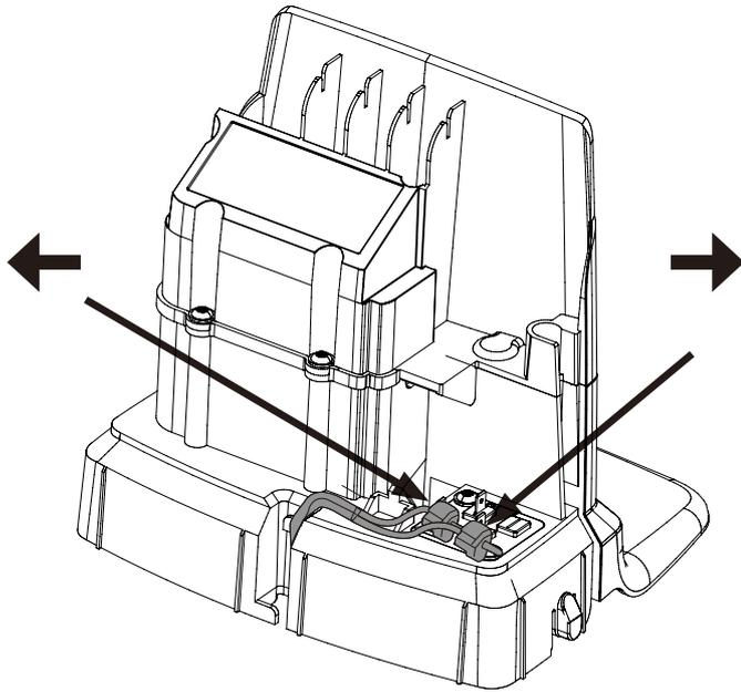
Przewód graniczny należy podłączyć do stacji ładowania w następujący sposób:
