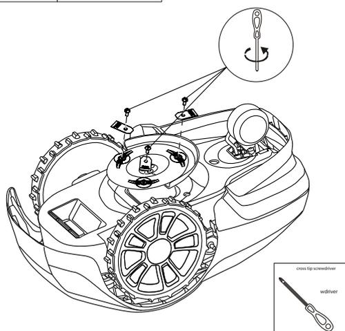
**FIGYELMEZTETÉS!** Nyomja meg a **START** gombot és távolítsa el a biztonsági kulcsot, mielőtt a késeket eltávolítaná, és viseljen védőkesztyűt. **FIGYELMEZTETÉS!** Csak a **GLOBE** késeket használjon: **333092355**
