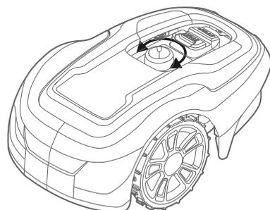
Ställ för de första veckornas klippning in klipphöjden på 60 mm för att se till att begränsningskabeln och guidekabeln inte klipps. Sänk därefter inställningen ett steg varje vecka tills den önskade klipphöjden nås.
