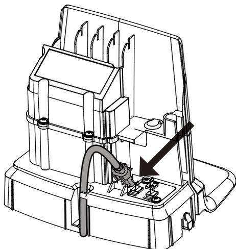
Zapojte nízkonapěťový kabel do nabíjecí stanice.
