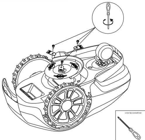
**VAROVANIE!** Stlačte tlačidlo **STOP** a pred výmenou čepelí vyberte bezpečnostný kľúč a nasadte si ochranné rukavice.
