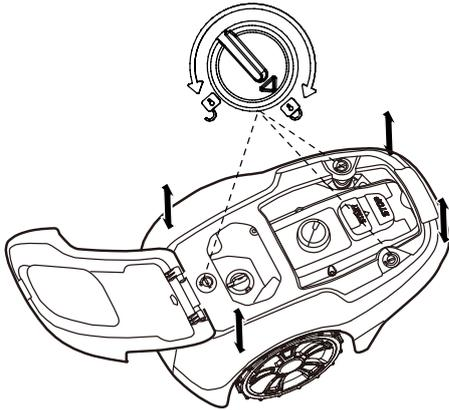
Käännä nappi lukituksen avausasentoon ja nosta rungon yhtä nurkkaa ylöspäin tukevasti. Toista kaikille neljälle nurkalle, jolloin runko ponnahtaa irti alustasta.
