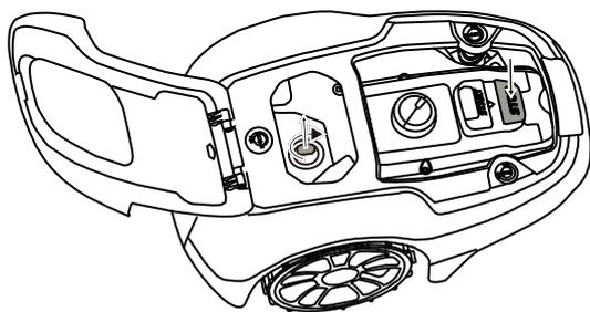
Apăsăți butonul **STOP** de pe robot și îndepărtați cheia de siguranță.
