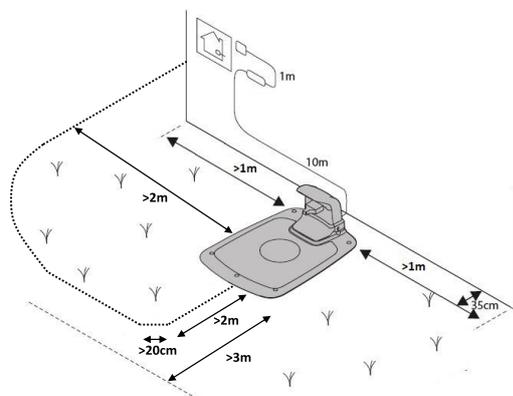
Проложите направляющий провод к месту соединения с контуром пограничного провода.
