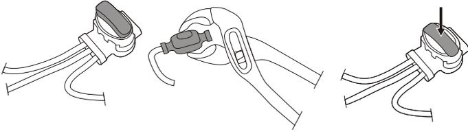
Поместите оба конца пограничного провода и направляющий провод в соединитель для срачивания внахлестку. Убедитесь, что оба провода установлены в соединитель так, чтобы их концы выдавались наружу соединителя.
