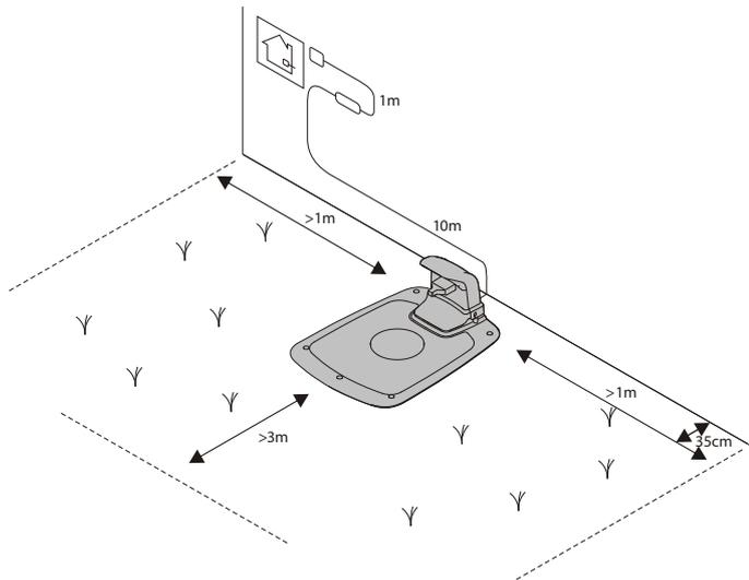
Poziționarea stației de încărcare după cum urmează:
