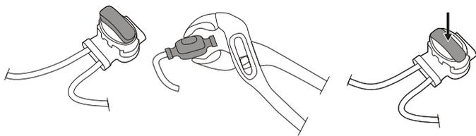
Wenn der Begrenzungsdraht zu kurz ist, verwenden Sie die mitgelieferten Spleiß- und Führungsdrahtverbinder, um den zusätzlichen Begrenzungsdraht wie folgt zu verbinden:
