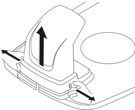
Entfernen Sie die Schutzabdeckung der Ladestation, indem Sie die Laschen auf jeder Seite der Basis eindrücken und die Abdeckung abnehmen.
