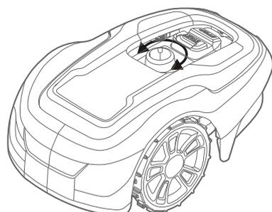
Per le prime settimane di utilizzo, impostare un'altezza di taglio pari a 60 mm per evitare di tagliare il cavo perimetrale e il cavo guida. Impostare un'altezza gradualmente inferiore ogni settimana fino a raggiungere l'altezza di taglio desiderata.
