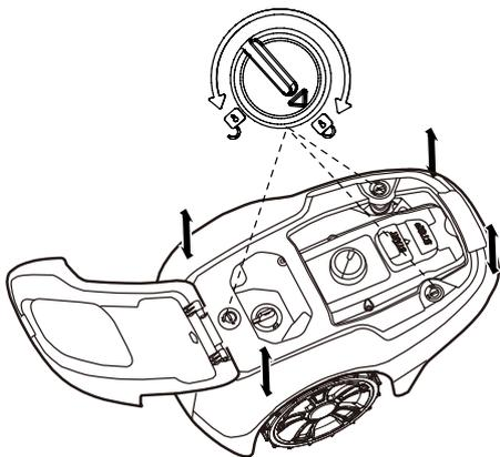
Gire el mando a la posición de desbloqueo y levante firmemente por una de las esquinas del cuerpo y repita para las cuatro esquinas, hasta que el cuerpo se suelte del chasis.
