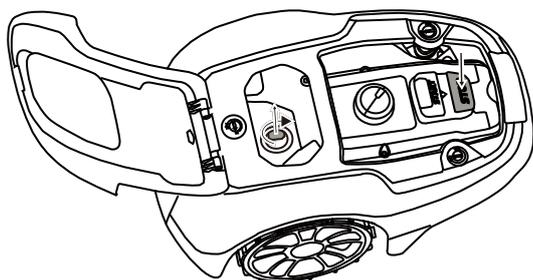
Stiskněte tlačítko **STOP** umístěné na sekačce a vyjměte bezpečnostní klíč.
