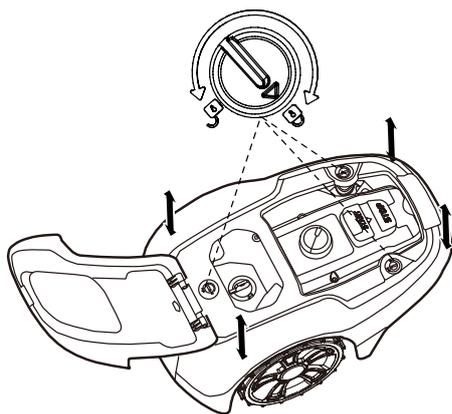
Vrid vredet till upplåst läge och lyft vid ett av karossens hörn och upprepa för alla fyra hörn, tills karossen lossnar från chassit.
