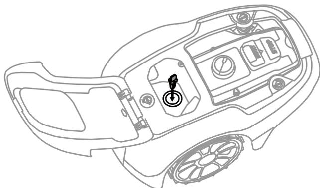
Introduceți cheia de siguranță în mașina de tuns și rotiți-o în poziția ON (I).
