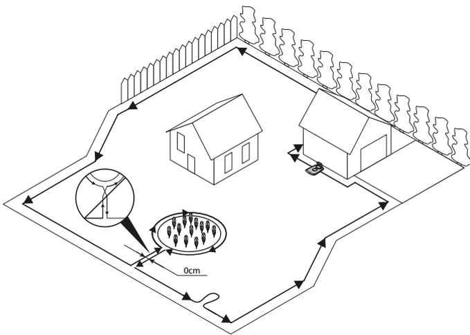
Befestigen Sie ein Ende des Schleifendrahts vorübergehend an einem Haken oder einem anderen Gegenstand an der Ladestation.
