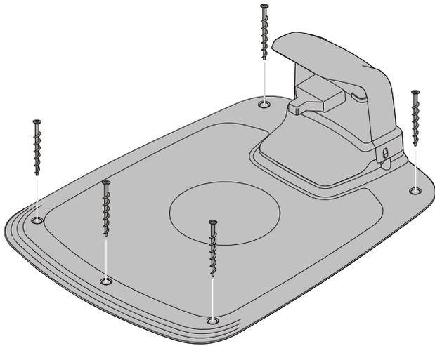
Pričvrstite stanicu za punjenje za tlo s pet vijaka isporučenih uz uređaj imbus ključem od 6 mm.
