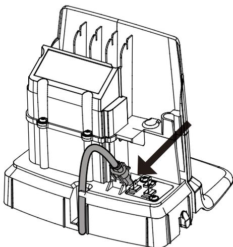
Conecte el cable de baja tensión a la estación de carga.
