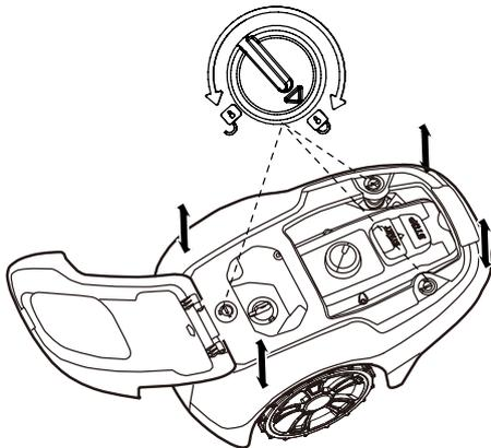
Drehen Sie die 3 Knöpfe in die Entriegelungsposition und heben Sie die Karosserie an einer der Karosserieecken fest an und wiederholen Sie dies für alle vier Ecken, bis sich die Karosserie vom Fahrgestell löst.
