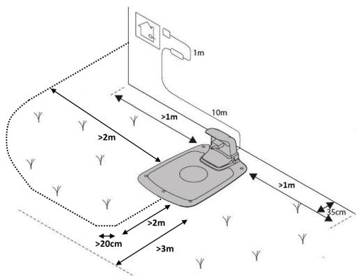
Fare arrivare il cavo guida fino all'occhiello del cavo perimetrale, nel punto cui verrà collegato il cavo guida.
