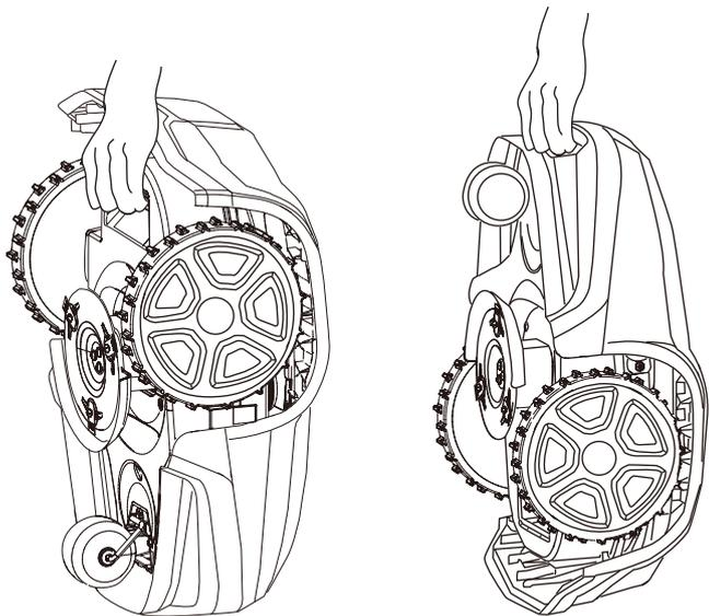
Pred dviganjem kosilnice pritisnite gumb **STOP** (USTAVI) in odstranite varnostni ključ.
