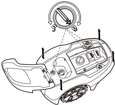
Zavrtite gumb v odklenjeni položaj in trdno primite ter dvignite za enega od vogalov glavnega dela ter ponovite na vseh štirih vogalih, tako da se glavni del sname z okvirja.
