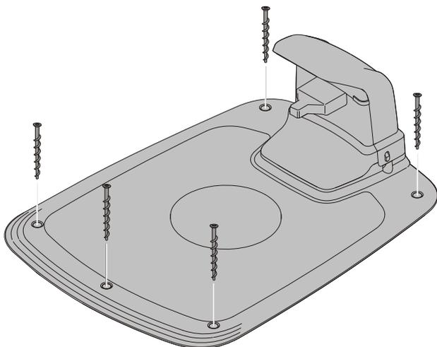
Fije la estación de carga al suelo con los cinco tornillos de fijación suministrados con una llave hexagonal de 6 mm.
