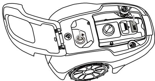
Drücken Sie die **STOP**-Taste am Mäher und ziehen Sie den Sicherheitsschlüssel ab.
