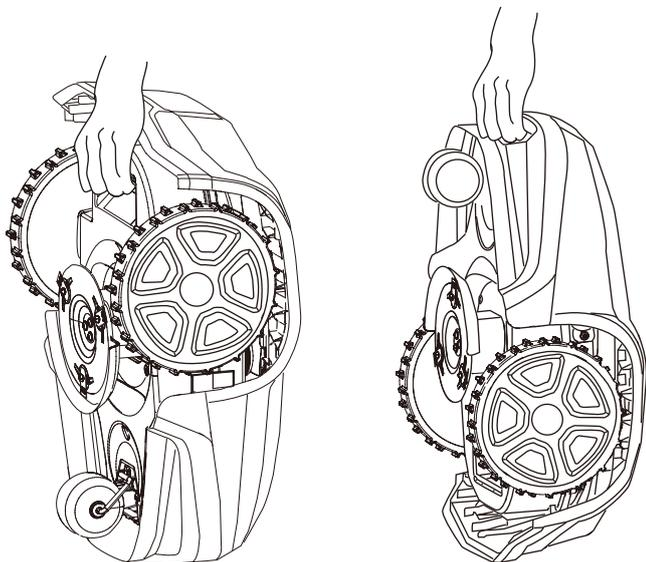
Pulse el botón de **PARADA** y retire la llave de seguridad antes de la elevación.
