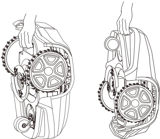
Drücken Sie die **STOP**-Taste und ziehen Sie den Sicherheitsschlüssel ab, bevor Sie den Mäher anheben.
