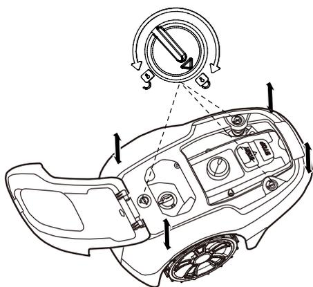
Tournez la molette sur la position déverrouillée tout en levant fermement l'un des coins de la carrosserie puis répétez à chaque coin jusqu'à ce que la carrosserie se sépare du châssis.
