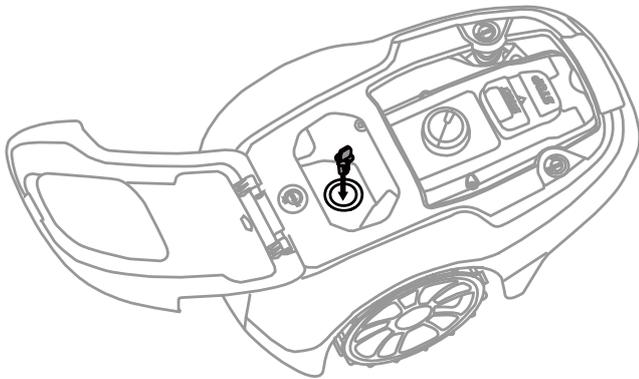
Vložte bezpečnostný kľúč do kosačky a otočte ho do polohy ON “(I)“.
