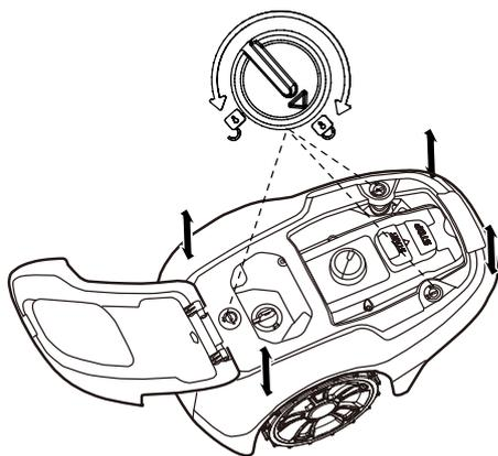
Поверните ручку в положение разблокировки и с усилием поднимите за один из углов корпуса, повторите операцию с четырех сторон — корпус отсоединится от шасси.
