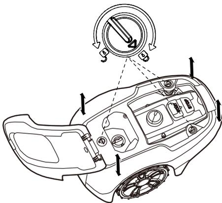
Drei knotten til opplåsingsposisjon og løft den fast i et av hjørnene på kroppen og gjenta for alle fire hjørnene, til karosseriet spretter løs fra kabinettet.
