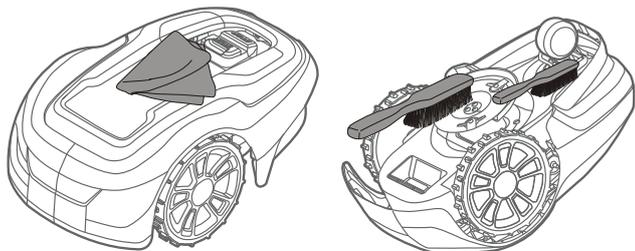
**VAROVÁNÍ!** Před čištěním stiskněte tlačítko STOP a vyjměte bezpečnostní klíč.
