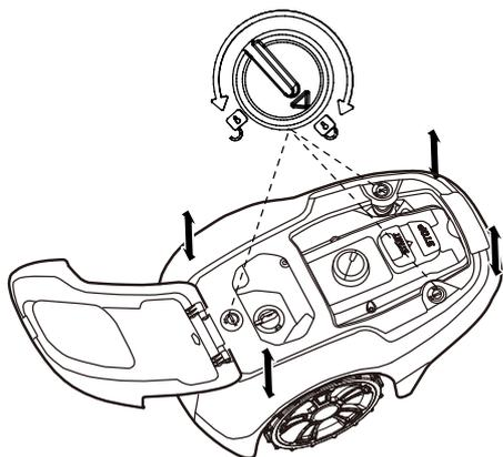
Fordítsa el a gombot a kioldás állásba, az egyik sarkánál fogva határozottan emelje fel a géptestet, ezt végezze el mind a négy sarokkal, amíg a géptest lazán le nem ugrik az alvárról.
